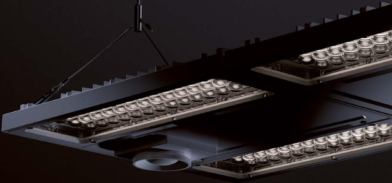
**ARNY 2** ist geeignet für die Decken-, Wand-, Pendel und Tragschienenmontage, beispielsweise in Lager- oder Sporthallen. Sie hat nicht nur ein starkes Design, sondern ist auch extra widerstandsfähig mit einer Schlagfestigkeit von bis IK10 und neu einem IP66 Schutz gegen Staub und starkes Strahlwasser. Zudem ist eine Ausführung für Extremtemperaturen von -30°C bis +65°C erhältlich.
